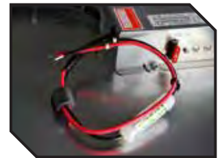
Anschlusskabel mit Sicherung Connection cable with fuse
